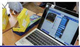
②さらに、マイクロビットでは、プログラミングをしているエディタ画面上で、シミュレーション表示させることもできるが、マイクロビット本体にプログラムを転送することで、装置単体で実行させることもできる。
